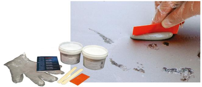
Watco Concrex<sup>®</sup> Feinfüller ist eine zweikomponentige Epoxidharz-Paste zum Füllen kleiner Spalten, Risse und Löcher in Betonböden. Wenn diese unbehandelt bleiben, können Fehlstellen in der Oberfläche nach der Anwendung einer Bodenfarbe hervorgehoben werden, insbesondere bei glänzenden Beschichtungen werden Unebenheiten deutlich. Concrex Feinfüller wird daher zur Vorbereitung vor dem Auftragen einer Beschichtung genutzt, um ein deutlich besseres Endergebnis zu erzielen.
